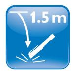
Fallprüfung: 12 Mal freier Fall aus einer Höhe von 1,5 m.
